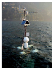
Sopra, un profilo termico del Lago di Como relativo al 9 ottobre 2008, ricavato dai dati del progetto "Plinius", finanziato da enti locali e dalla Fondazione Cariplo. Il progetto utilizza tre stazioni fluttuanti LDS (Lake Diagnostic System) - foto a sinistra - per la misura in tempo reale dei parametri meteorologici e del profilo termico lacustre dalla superficie al fondo, sviluppata dal Centre for Water Research (CWR) della University of Western Australia che li mette a disposizione on line sul proprio sito ( www.cwr.uwa.edu.au ).
